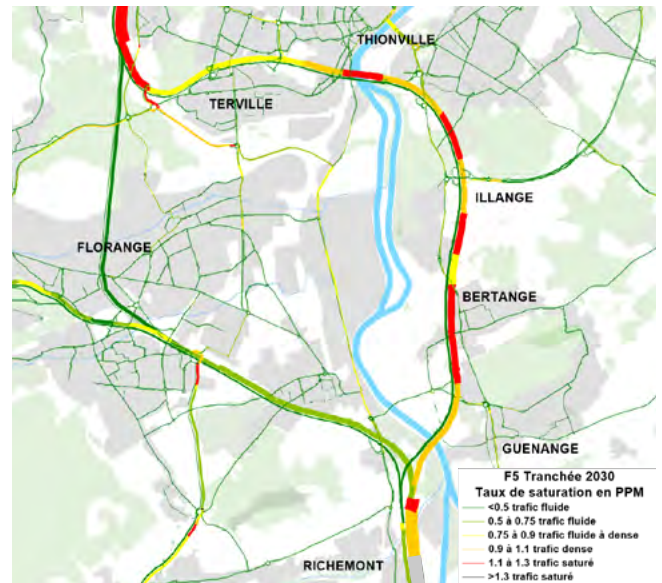
Figure 41. Taux de saturation pour F5-Tunnel de surface (à gauche) et F5-Tunnel profond (à droite) pour la période de pointe du matin en 2030
