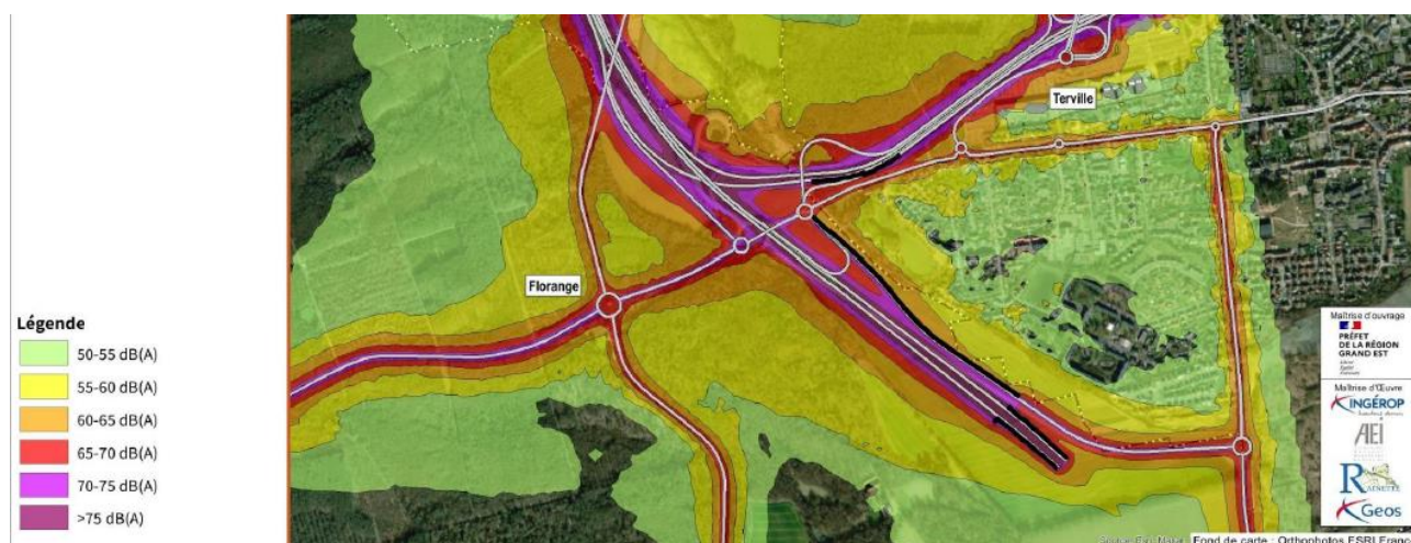
Situation du bruit de jour avec protection acoustique
